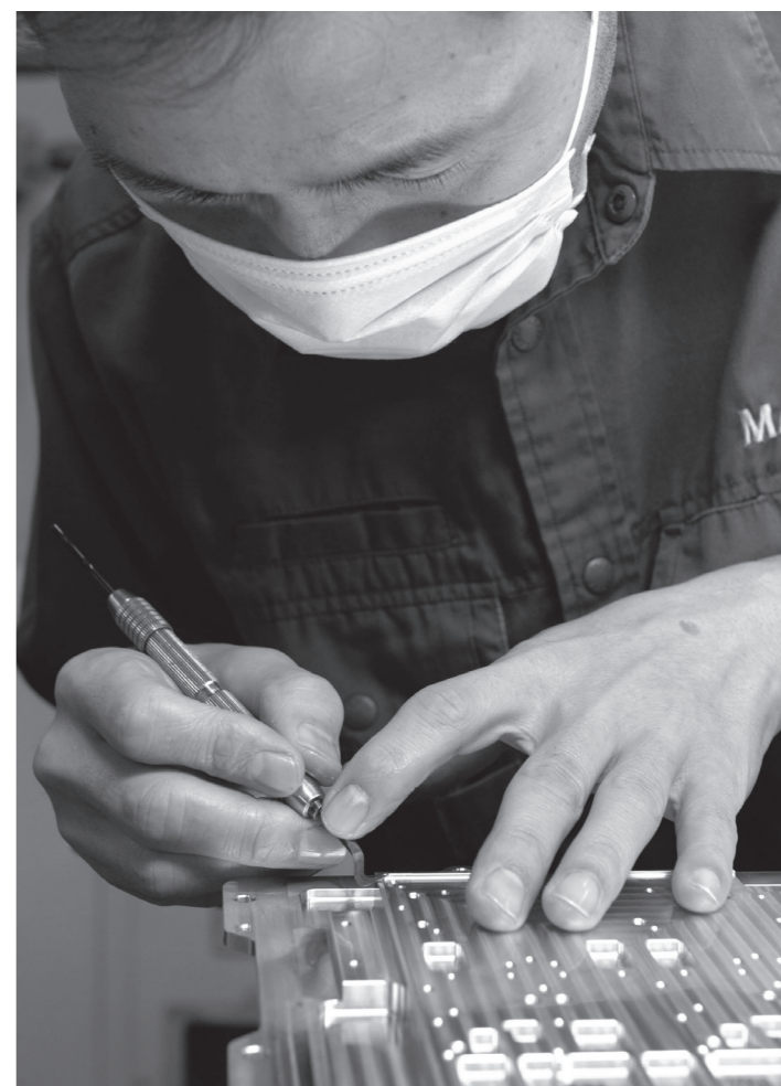
▲最終仕上工程で微細バリの除去作業
