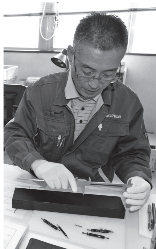
▲完成品の抜き取り寸法検査
